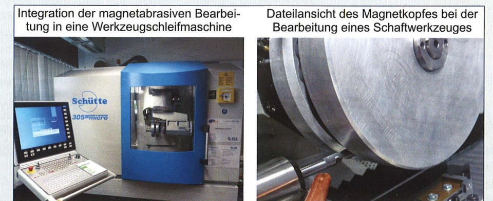
Bild 2 Umsetzung des Verfahrens innerhalb der Werkzeugschleifmaschine Schütte 305micro.
